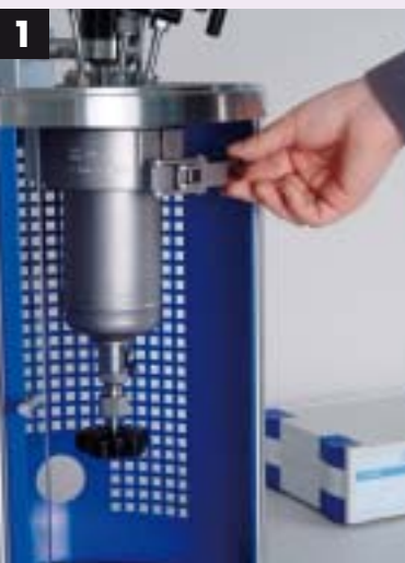
Schnellverschluss öffnen Open quick action closure
