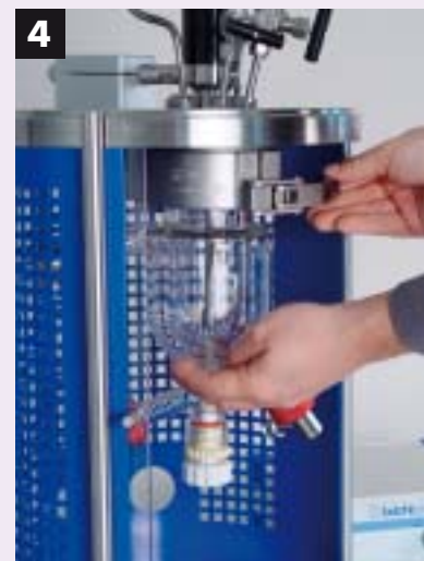
Schnellverschluss schliessen Close quick action closure
