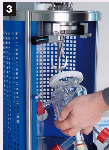
3 neues Gefäss einführen Insert new vessel
