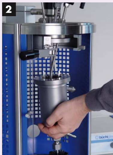
2 Gefäss entfernen Remove vessel
