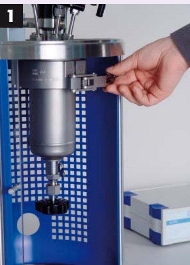
1 Schnellverschluss öffnen Open quick action closure
