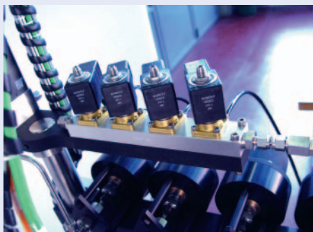
Manyfold with control valves for massflow-controller Verteiler mit Steuerventilen für Durchflussmessung
